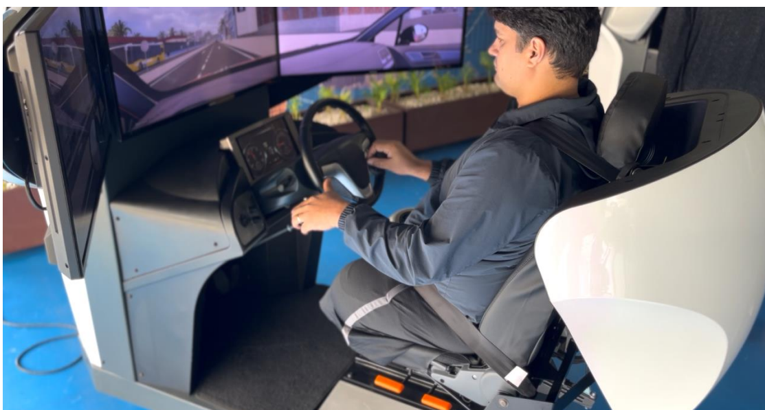
Figura 1 - Simulador de direção veicular para pessoa com deficiência, em testes finais de desenvolvimento, perspectiva à esquerda do condutor. Fonte: própria.
