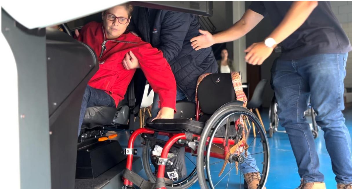
Figura 2 - Simulador de direção veicular para pessoa com deficiência, em testes finais de desenvolvimento, condutor com deficiência nos membros inferiores. Fonte: própria.
